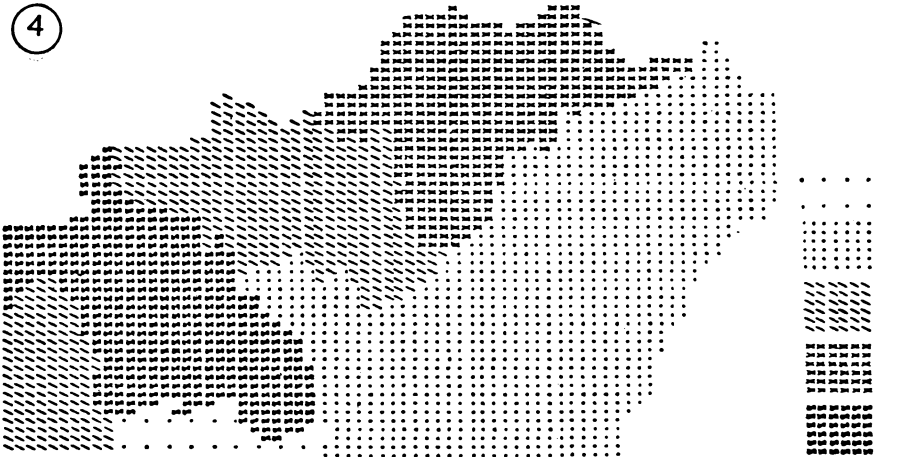
Рис. 3. Образцы машинных карт. Изолнии (1) и блок-диаграмма (2) построены чертежным автоматом; изолининое изображение (3) и картограмма (4) выполнены линейно-печатающим устройством.
